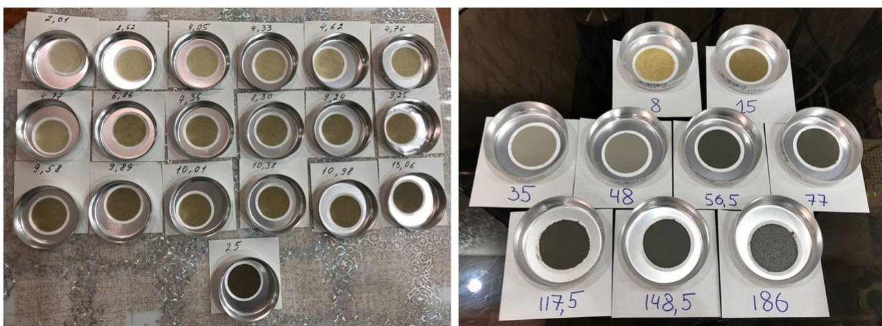
Рисунок 7 — На фотографиях представлены фильтры сразу после процесса фильтрования: 2019 г. (а); 2021 г. (б). Цифрами подписано значение мутности морской воды в пробе, определённое портативным турбидиметром TN400
