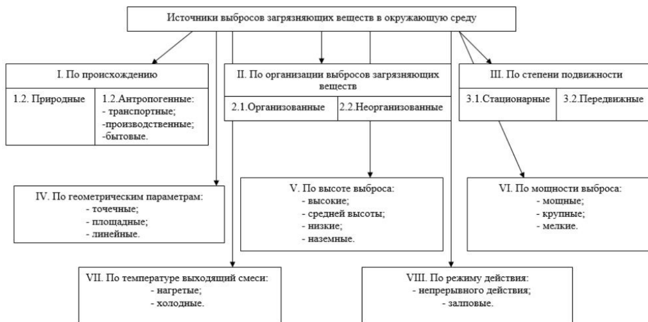
Рисунок 2.2 – Схема классификации источников загрязнения атмосферы [152, 153]
