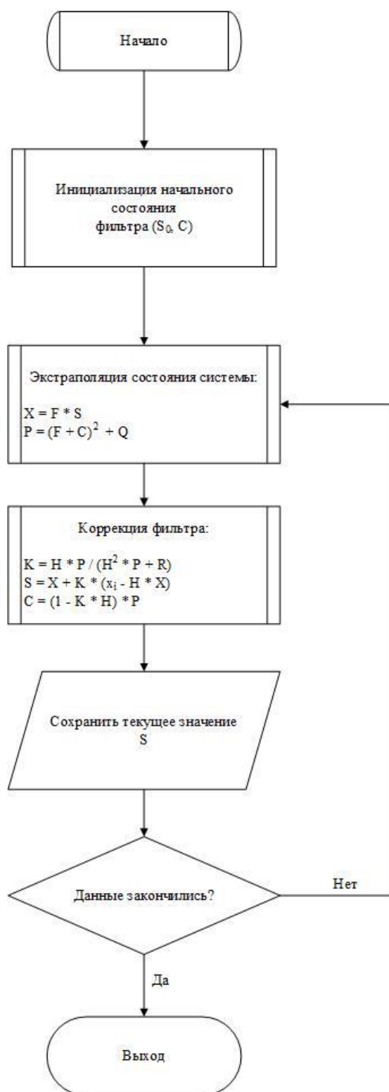
Рисунок 40. Структурная блок-схема алгоритма фильтра Калмана-Бьюси
