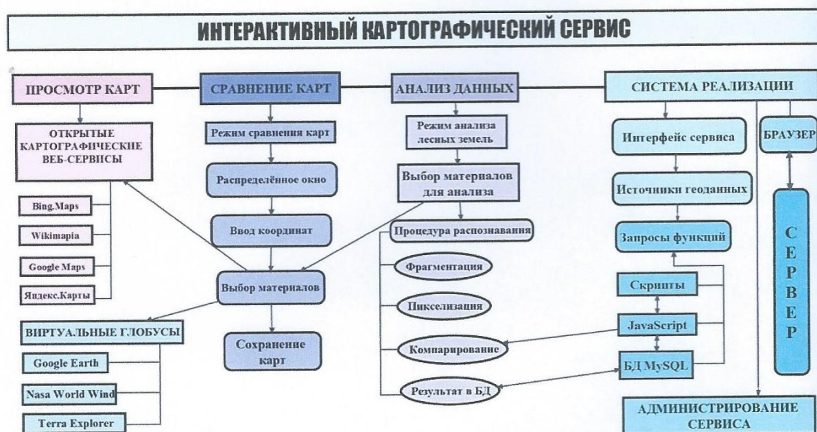
Рисунок 2 –Модель компонентов интерактивного картографического сервиса.
