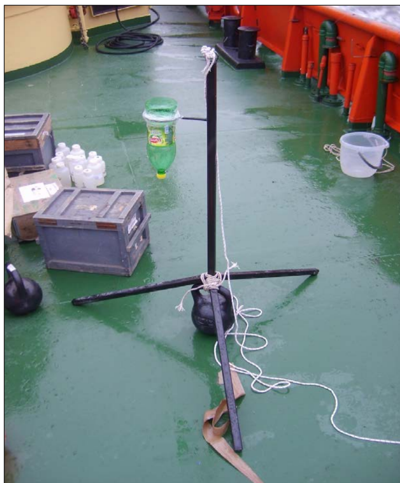
Рисунок 2.8 – Внешний вид седиментационной ловушки до установки
