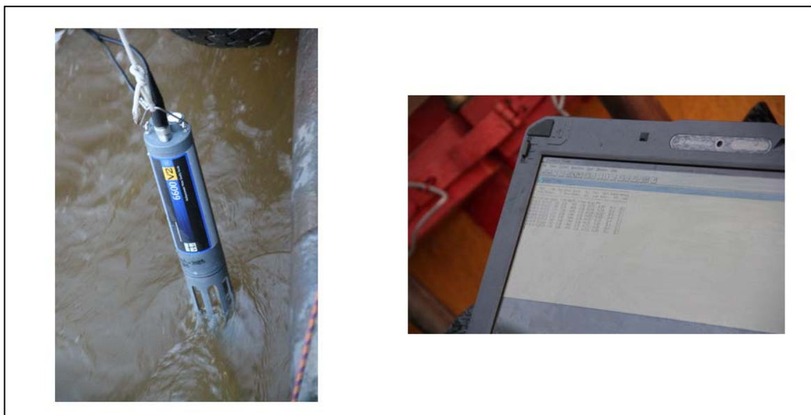
Рисунок 2.3 – CTD-зонд YSI 6600 с дополнительным оборудованием (оптическим датчиком мутности)
