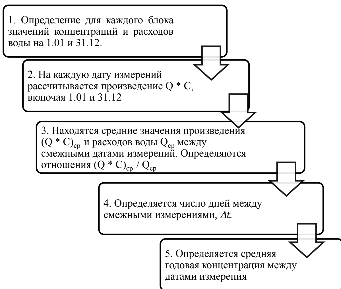
Рисунок 4.1 – Блок-схема последовательности вычислений при оценке среднегодовых значений концентраций по комплексной методике учета особенностей гидрохимической информации.
