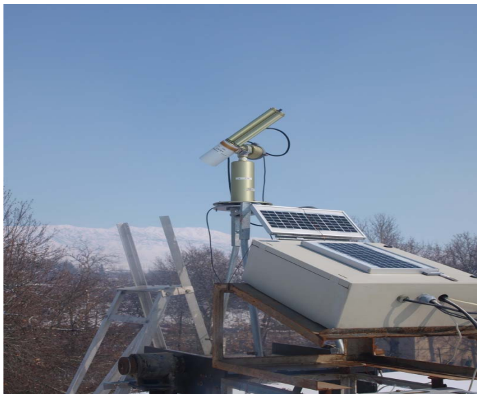
Рис. 2.13. Солнечный фотометр Cimel CE-318 в работе установленный на станции наблюдения в г.Душанбе.
