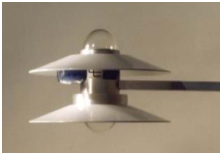
Рис.2.15. Альбедометр CE 180.2A (Фирмы Cimel, Франция) для измерения глобальной солнечной радиации, отраженной радиации и альbedo поверхности.
